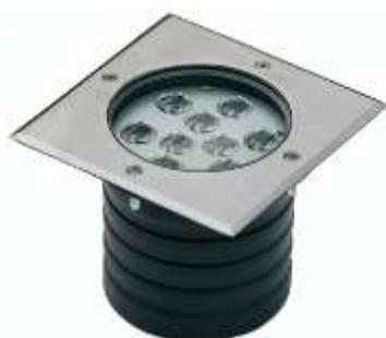
Solspot 9 asymétrique axe 15°, versions fixes, angles de 5°, 12°, 20°, 30° et 45°, puissances de 16 Watts. Monochrome 100-240V ou gradable PWM, RGB à contrôleur DMX intégré, 12 VDC
