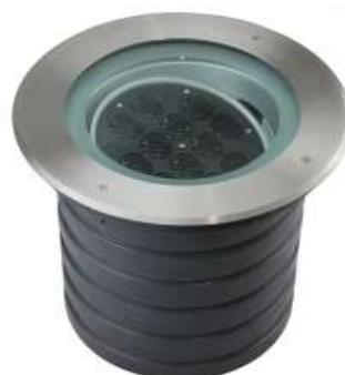
Solpost 7 et 12, de 12 à 60 Watts, platine LED sur cardan 0-15°, angles de 3.5°, 12°, 20°, 30°, 45°. Monochrome 100-240V ou gradable PWM 24VDC, RGB ou RGBW4en1, à contrôleur DMX intégré, 24 VDC
