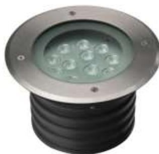
Solspot, versions fixes, angles de 5°, 12°, 20°, 30° et 45°, puissances de 1.5W à 40 Watts. Monochrome 100-240V ou gradable PWM, RGB à contrôleur DMX intégré, 24 ou 36 VDC selon puissance
